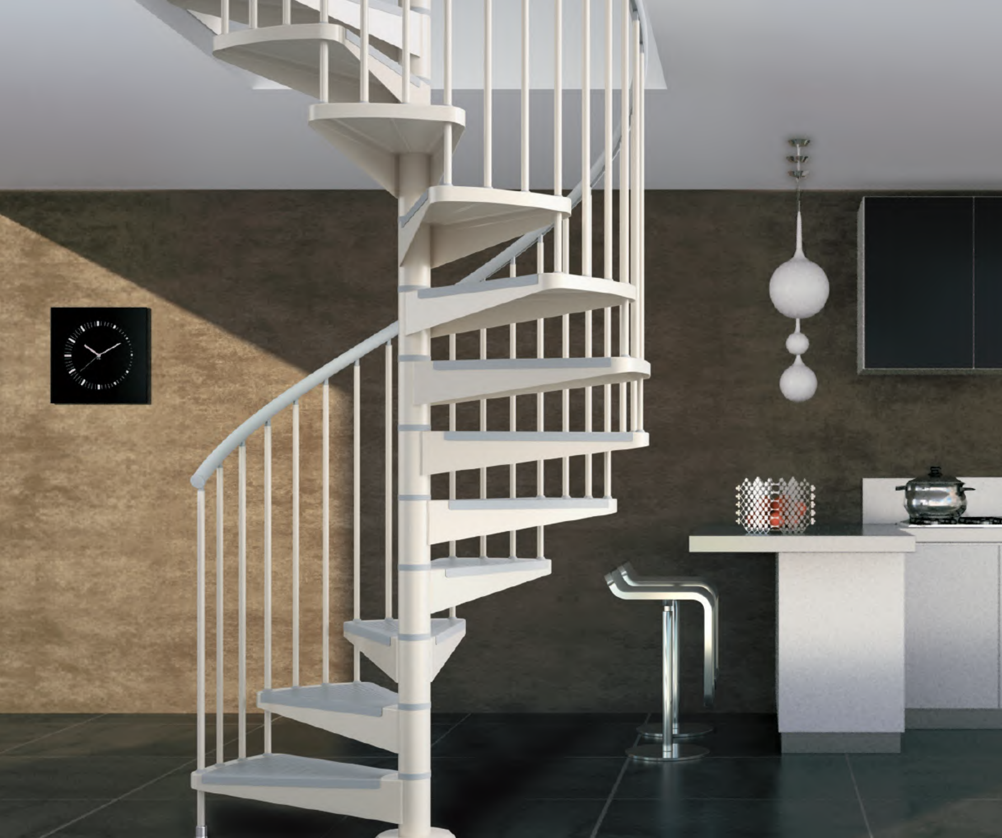
IT ] Scala a chiocciola in acciaio verniciato con piano di calpestio protetto da una pedana in PVC. Corrimano, pedane e accessori in grigio. La ringhiera è disponibile in due versioni. Il corrimano è realizzato da un profilo estruso in PVC.
